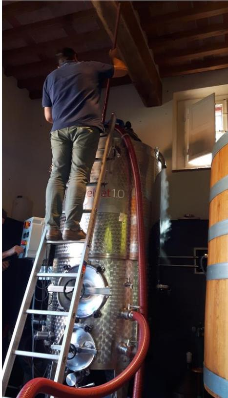
*Figura 14. Esecuzione del rimontaggio*
